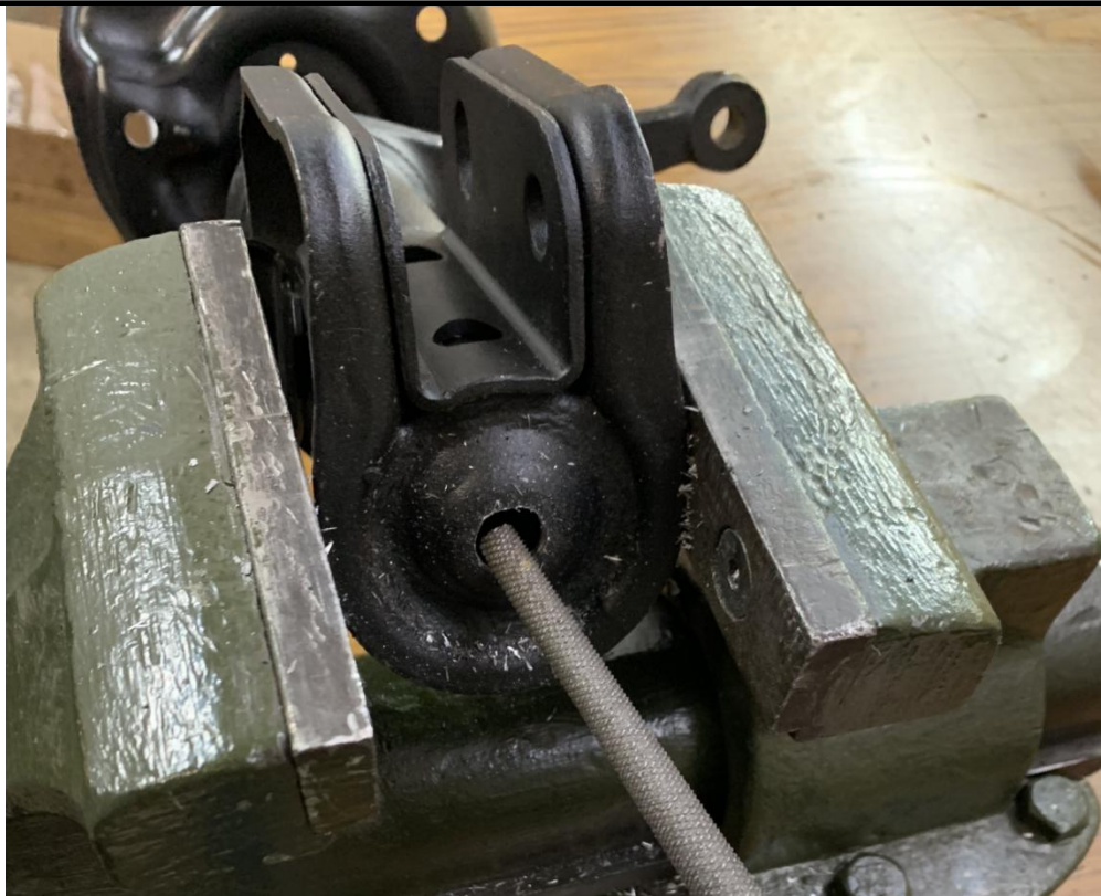
Шаг 21. Круглым напильником или надфилем зачистить заусенцы.
