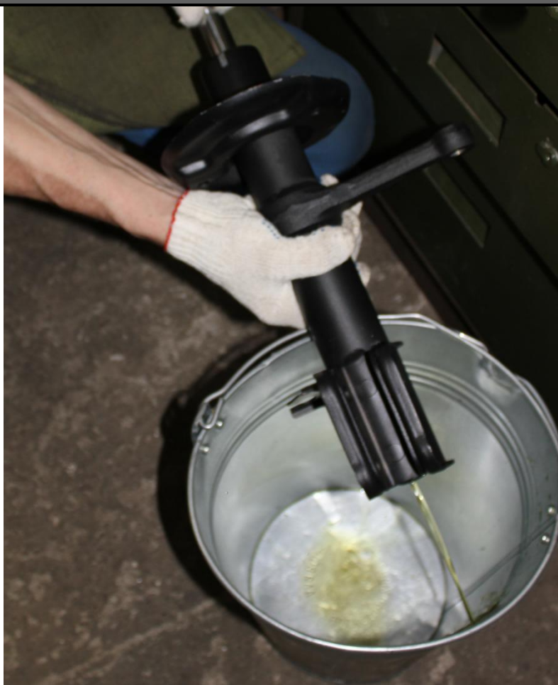
Шаг 11. Слить амортизаторную жидкость в ёмкость.
