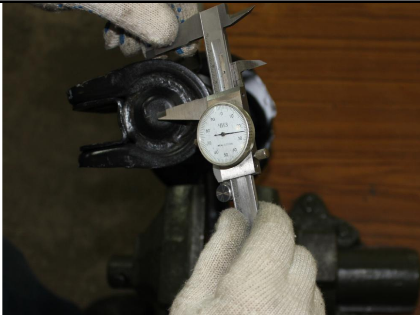
Шаг 6. Выставить штангенциркуль на половину измеренного размера.
